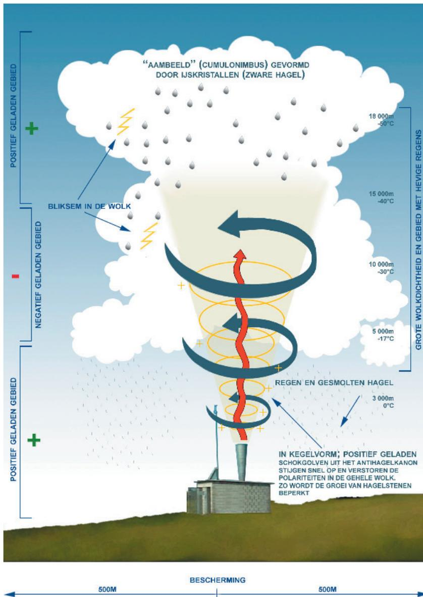
Avec ce canon, on s'élance des ondes de choc (énergiques) ionisantes toutes les 5 secondes. En un rien de temps, celles-ci atteignent l'atmosphère la plus haute, jusqu'à 15000m, à une température de  $-50^{\circ}\text{C}$ , où la grêle se développe. Une partie des ondes est réverbérée par les nuages et la tropopause. Celles-ci heurtent les ondes montantes.
